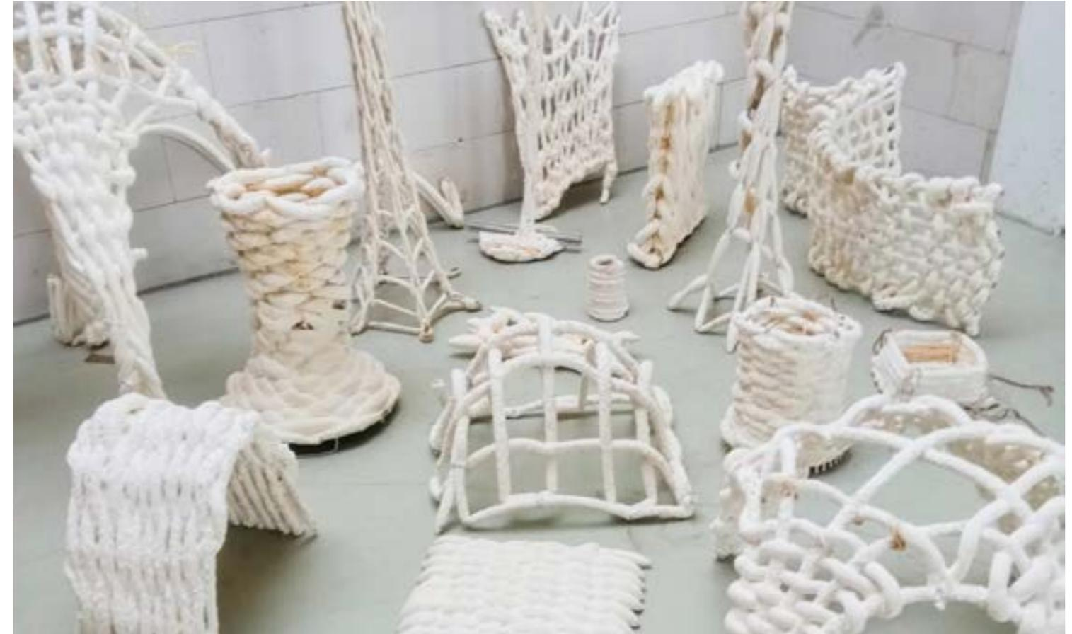
Filament-basierte Mock-ups mit Myzelkompositen. Bild: IBK Universität Stuttgart / Eliza Biala)
